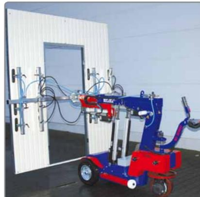
Idéal: Système d'aspiration avec ventouses étroites\* pour tôles trapézoïdales.
