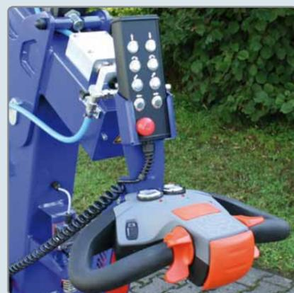
Commande à distance filaire et volant multifonction pour un meilleur confort d'utilisation.
