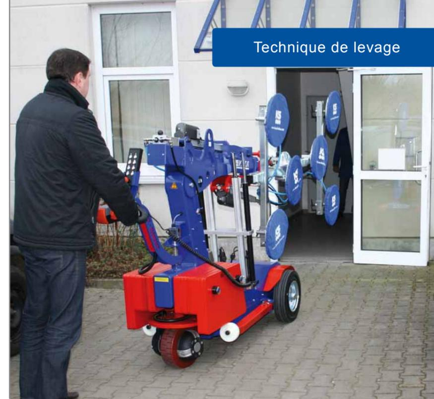
Très maniable: l'unité de pivotement à 90° permet de basculer latéralement l'unité d'aspiration avec la charge pour les passages étroits
