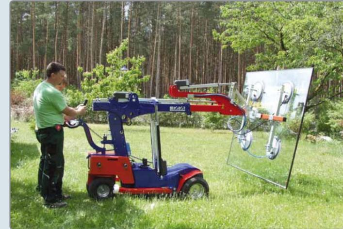
Course télescopique de 900 mm\* pour un déport jusqu'à 1.502 mm (ou 1.331 mm) à l'avant des roues.
