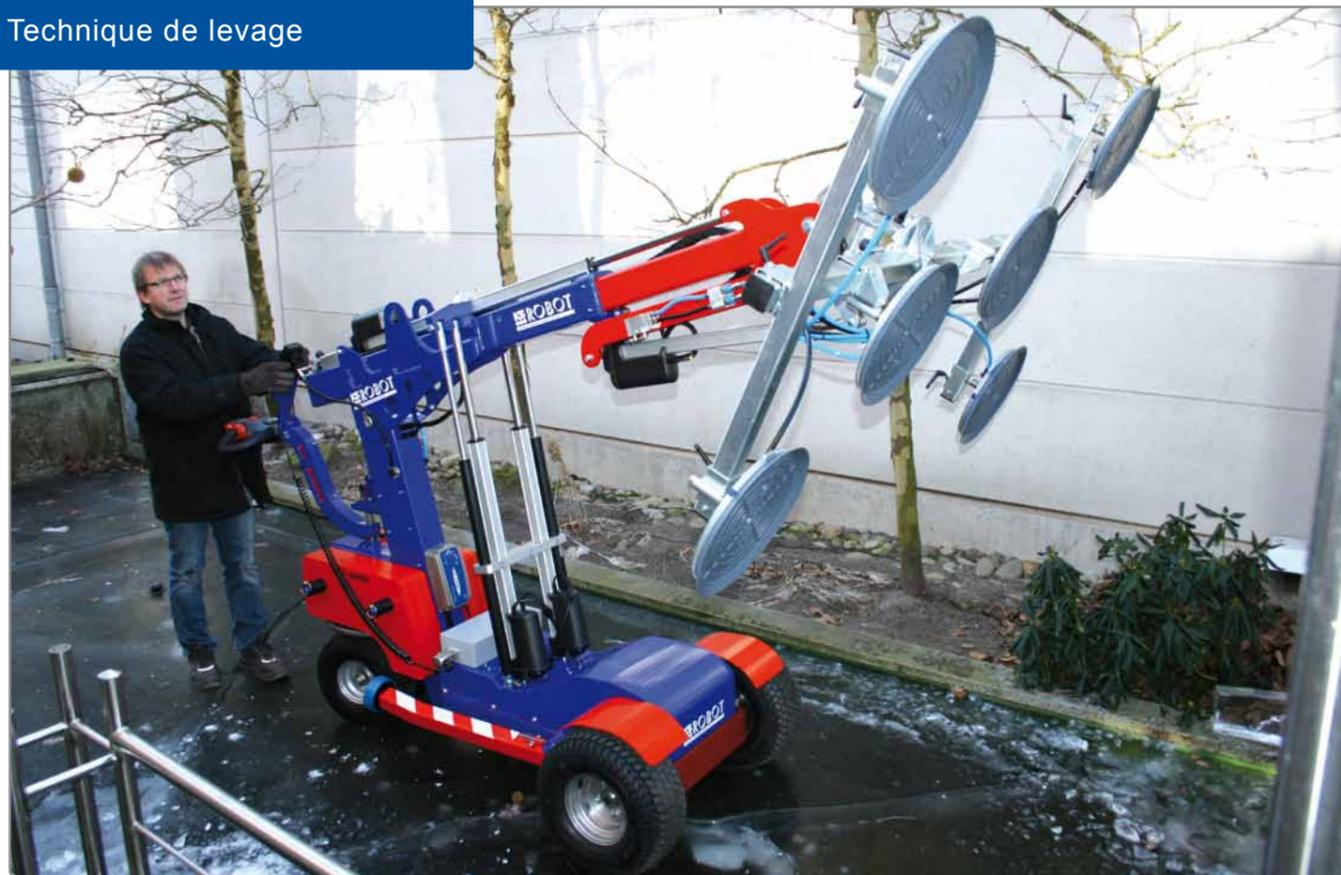
KS Robot 600 Offroad lors d'un test de résistance : même sur la glace, il se comporte bien. Un bassin gelé est le seul accès possible pour entreprendre des réparations de vitrages sur cette toiture.
