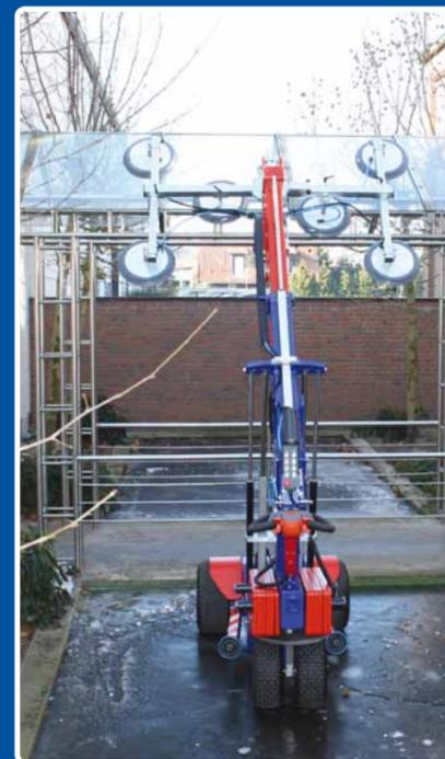
Un système télescopique spécialement long fait ses preuves lors d'un montage hauteur de 3 m.
