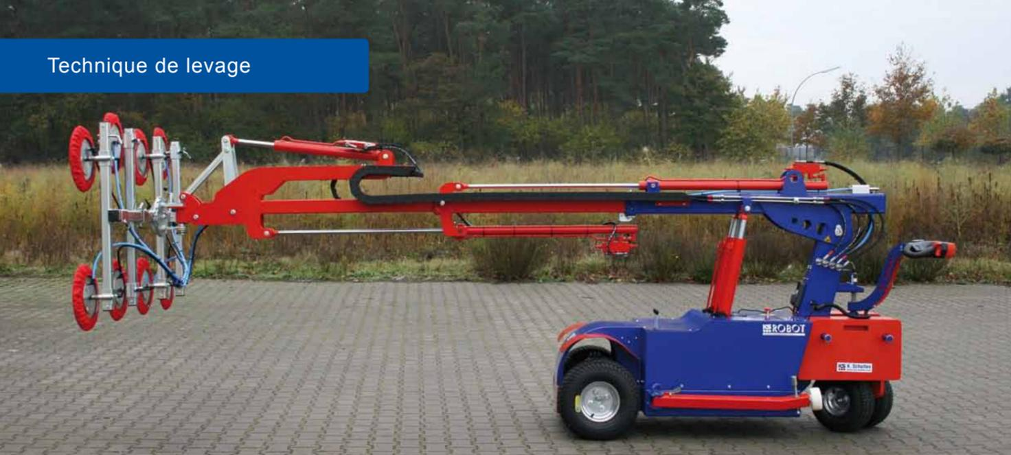
▲ Système télescopique hydraulique double pour une portée de 2 x 1000 mm.
