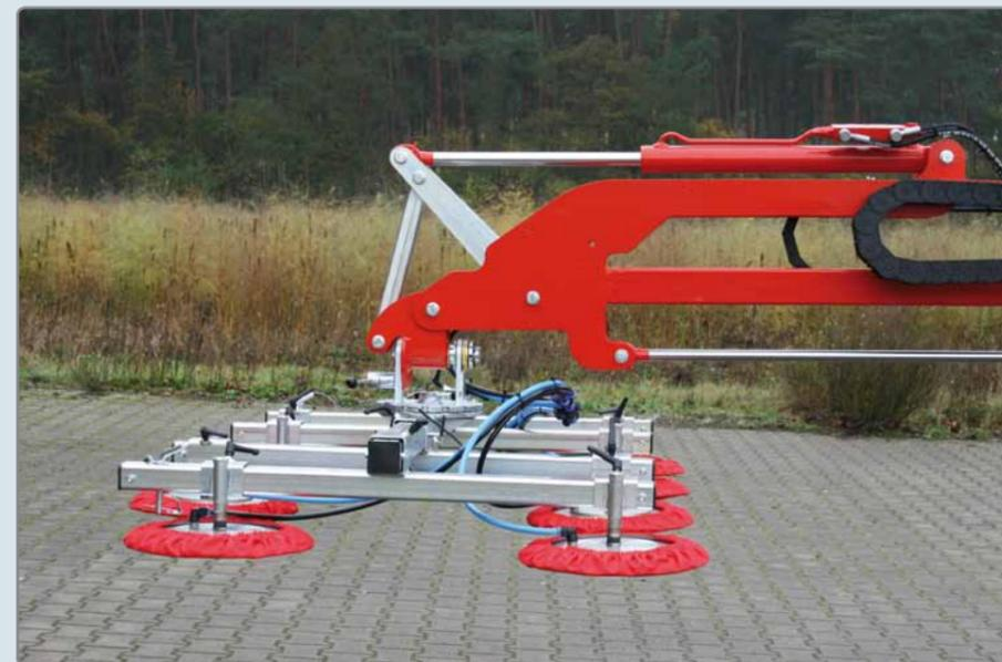
▲ Articulation spéciale sol/plafond avec système de basculement électrique pour la pose de vitrages en toiture.
