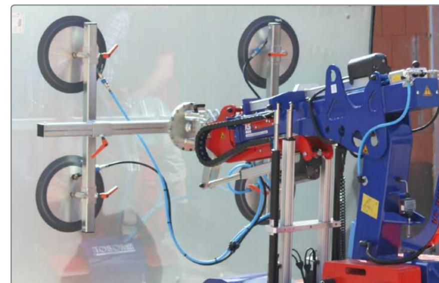
Le système électrique spécial pivotant / basculant facilite la pose: tous les mouvements de pivotement / basculement sont commandés électriquement.
