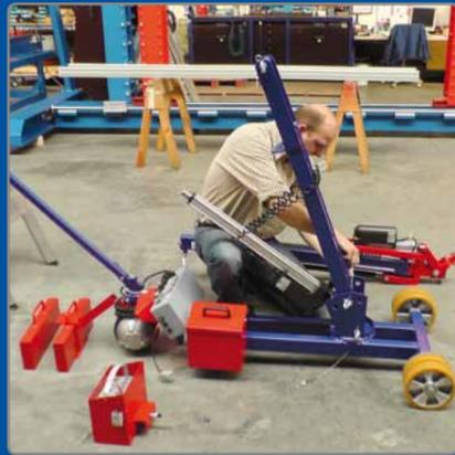
Le châssis, l'axe ainsi que le mât de levage sont montés en premier
