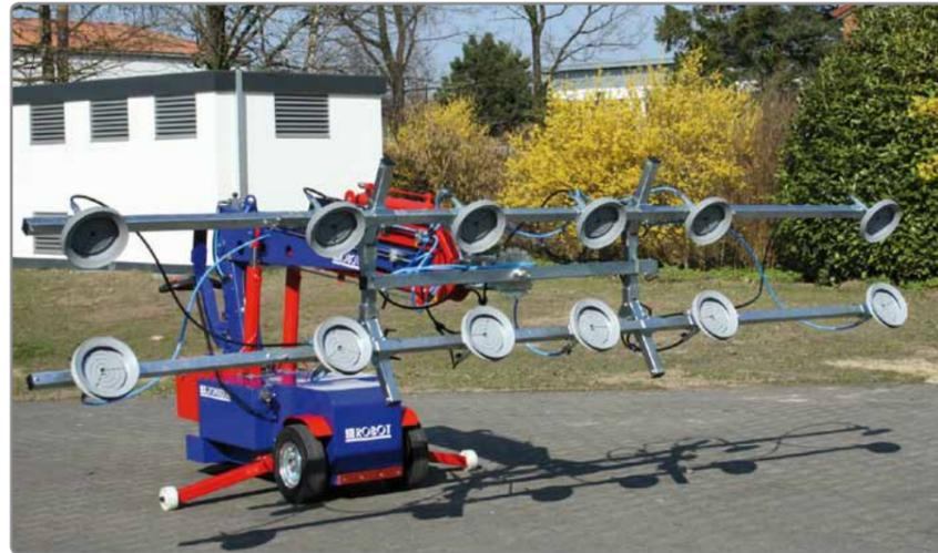
KS Robot 1000 avec système à ventouses pour vitrages bombés\*.
