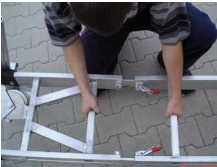
Le KS Jack est composé de deux éléments en aluminium léger
