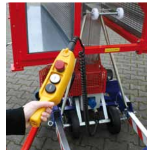
Une commande à distance par câble* garantit un meilleur confort d'utilisation
