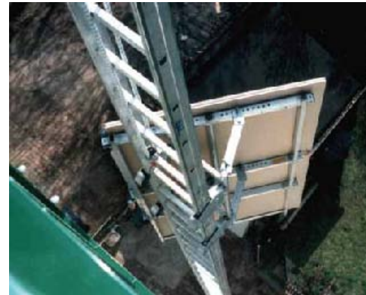
Grâce à un treuil à commande électrique, l'objet est transporté en toute sécurité dans l'étage souhaité
