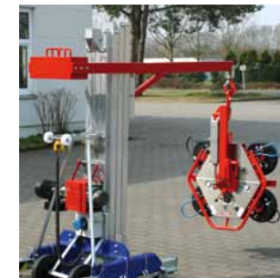
Dispositif de réception spécial pour KS VacuPower avec déport au-delà des roues pour passer au dessus des obstacles
