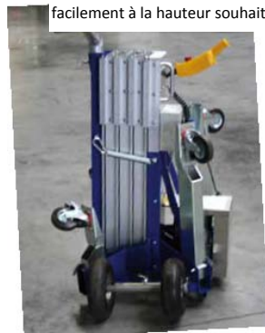
Le KS Wiga est compact et peu encombrant lorsqu'il est replié
