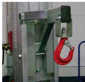
Crochet – par ex. pour palonnier ou sangles de levage
