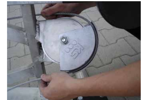
Le transport de la charge se fait par le biais d'une solide poulie avec câble métallique
