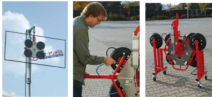
Deux circuits indépendants d’aspiration assurent la sécurité nécessaire lors de la pose Simple changement et extension des bras de levage pour des charges utiles plus lourdes Deux supports à roulettes servent de système de transport pour le KS VacuPower
