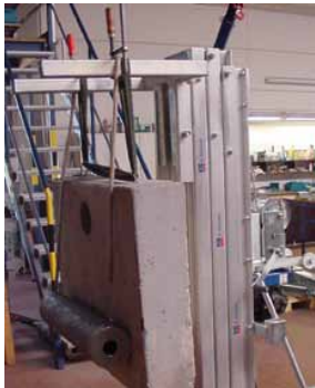
Fourche pour la manutention d'éléments de construction lourds
