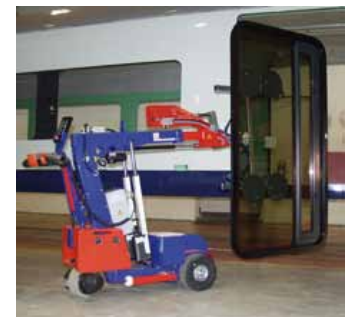
KS Robot 280 lors de la pose de portes sur les trains ICE
