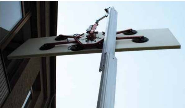
Mât de levage avec crochet de réception pour sangle de levage ou palonnier à ventouses
