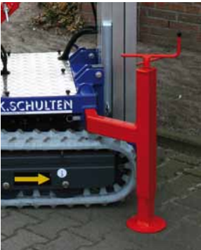
Sûr : 4 pieds stabilisateurs pour une mise à niveau
