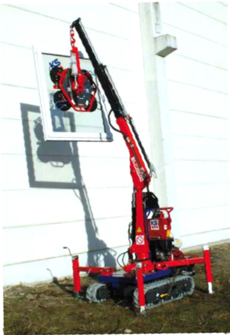
KS MultiCrawler C500 équipé d'un système à ventouses KS VacuPower* très approprié pour le levage de vitrages, de plaques de bois ou de pierres, de panneaux PVC, alu et de nombreux autres matériaux encombrants
