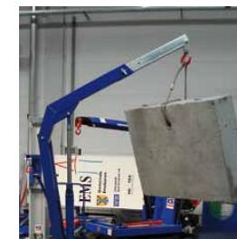
Le KS GK se distingue également lors du montage et du démontage. Le bras de grue peut être basculé vers l'arrière, ce qui permet de ranger facilement le dispositif dans une voiture de chantier.. Si l'on souhaite économiser encore plus de place, il est possible de démonter facilement le KS GK puis de la remonter sans avoir à fournir beaucoup d'efforts.
