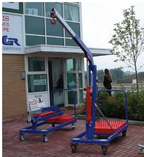
Le bras de grue est réglable manuellement dans 4 positions de longueur. La hauteur de levage est réglée à l'aide d'une pompe hydraulique manuelle. De plus, l'abaissement de la charge peut être réglé de manière précise sur un volant, de telle sorte que le vitrage peut être positionné au millimètre près
