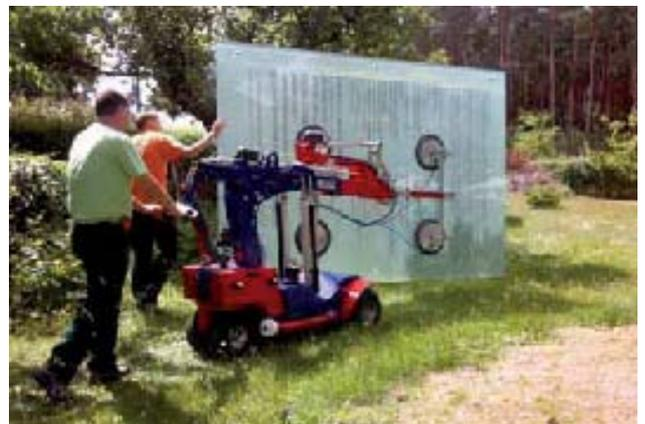
Pivotement latéral de 90° de la charge : idéal pour le passage à travers les portes
