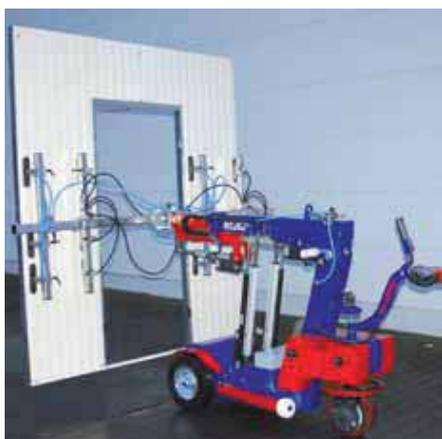
Idéal : Système d'aspiration avec ventouses étroites\* pour tôles trapézoïdales \*disponible en option
