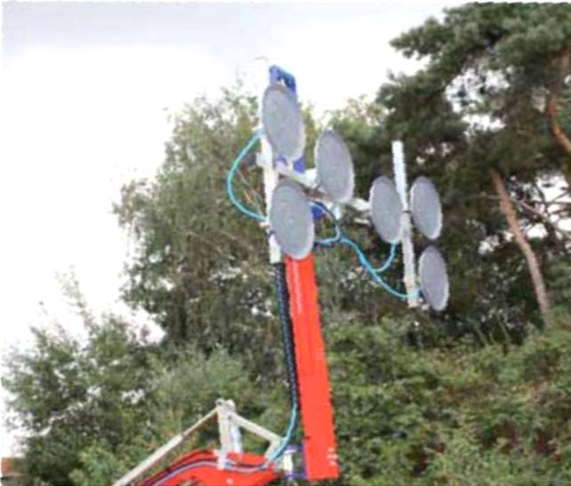
Prolongateur télescopique électrique\* pour presque tous les robots, limité à 250 kg de charge utile
