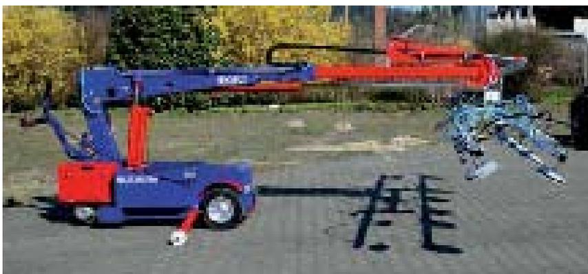
Polyvalent: le système de ventouses est approprié aux vitrages bombés\* et aux vitrages plans
