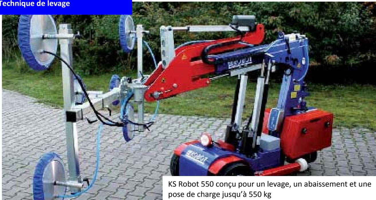
KS Robot 550 conçu pour un levage, un abaissement et une pose de charge jusqu'à 550 kg
