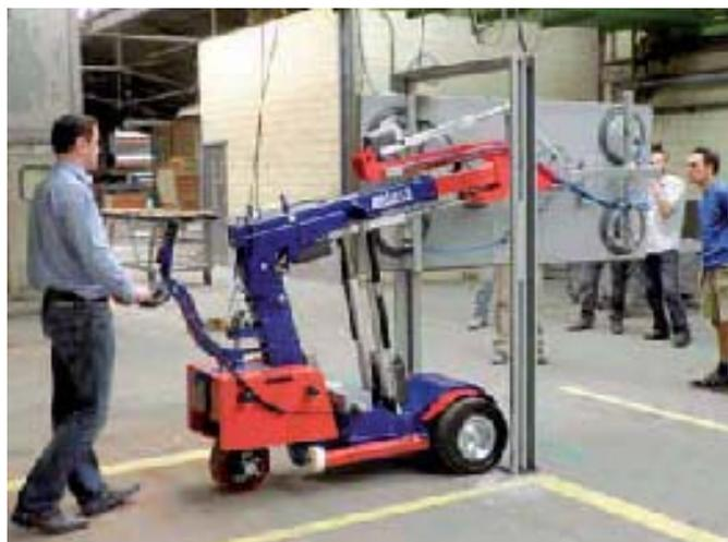
Le KS Robot 550 au cours du test de dureté Avant de monter des portes coupe-feu dans des cellules de prison en Belgique, il doit s'affirmer chez le client en espace très restreint.
