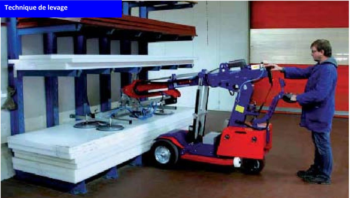
Une classe à part: la rotule pivotante/basculante électrique, qui permet de prendre les éléments lourds directement dans les étagères
