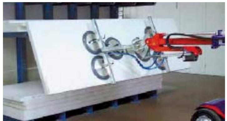
Des panneaux PVC pesant 600 kg peuvent être pris directement sur l'étagère, être posés sur le sol et basculés vers le plafond
