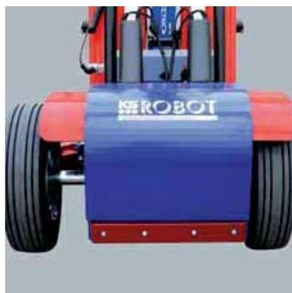
Déplacement latéral de jusqu'à 100 mm pour un ajustage précis du vitrage lors de la pose
