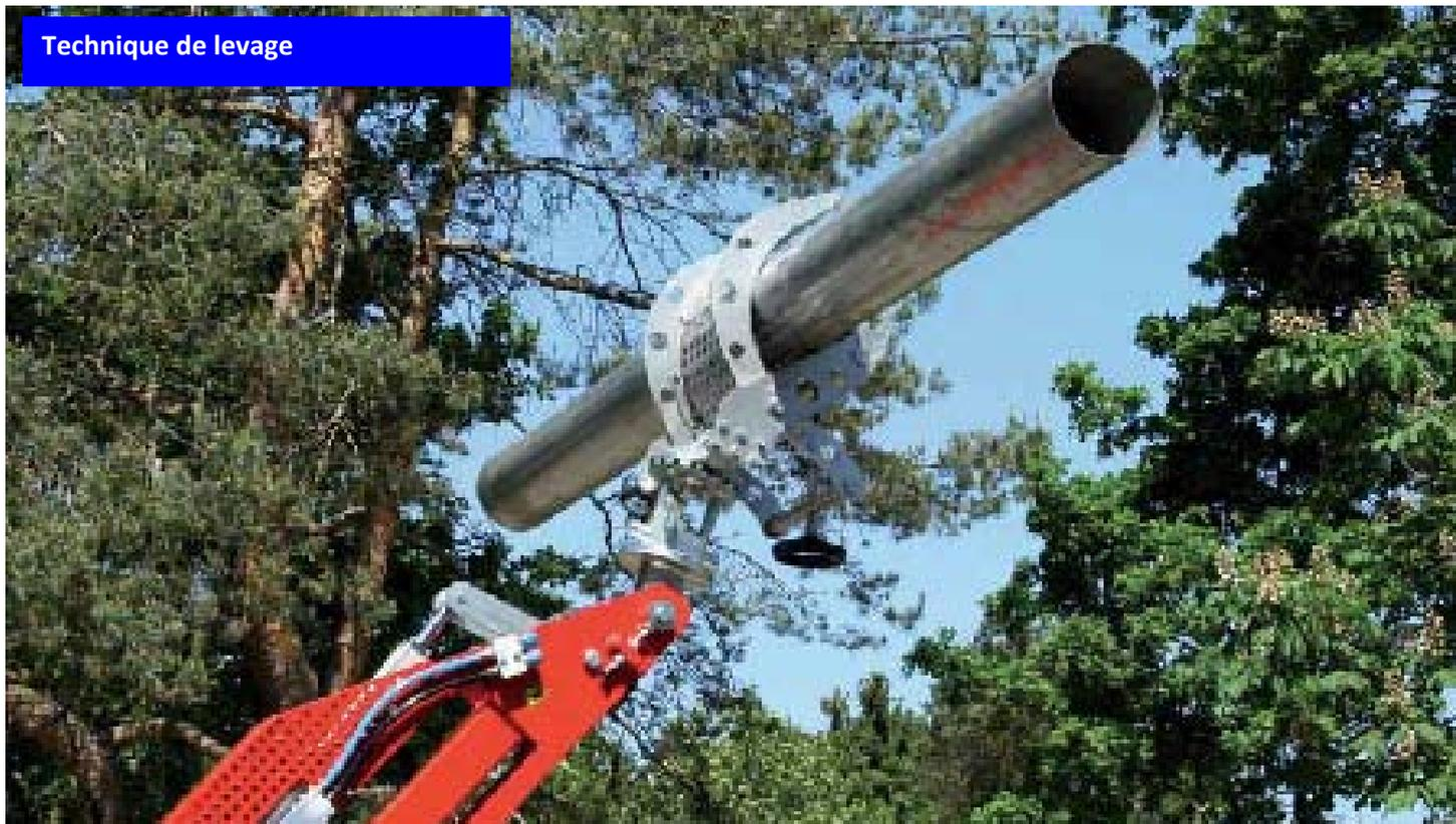
Griffes spéciales\*, pour rouleaux de revêtement de sol, de tuyaux PVC ou métal, possibles en version électrique ou mécanique.
