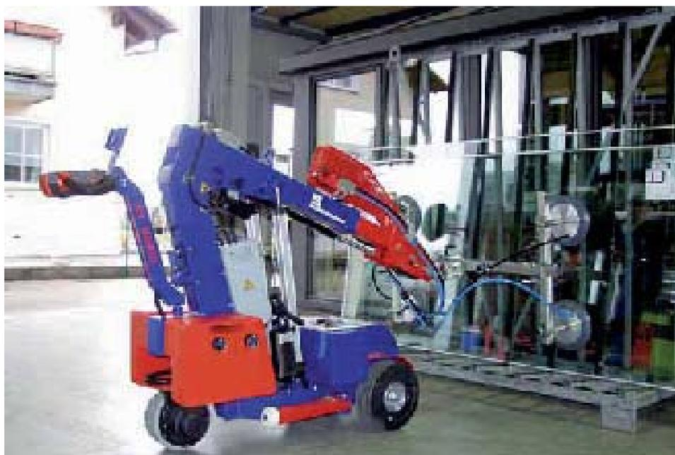
KS Robot 280 pour le transport de matériaux lourds – jusqu'à 280 kg – et le vitrage d'éléments de fenêtres et de façades
