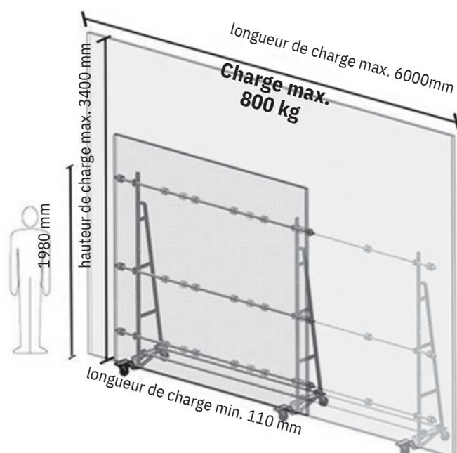
Chariot HDL avec robot de pose Winlet 600.
